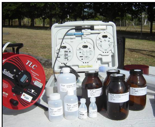
Illustration 4 : Photographie du matériel et flacons utilisés lors des prélèvements (de gauche à droite : sonde piézométrique indiquant en plus la conductivité de l'eau et sa température, flacons en polyéthylène et en verre ambré, malette d'analyses physico-chimiques in situ , échantillonneur en polyéthylène à usage unique).
