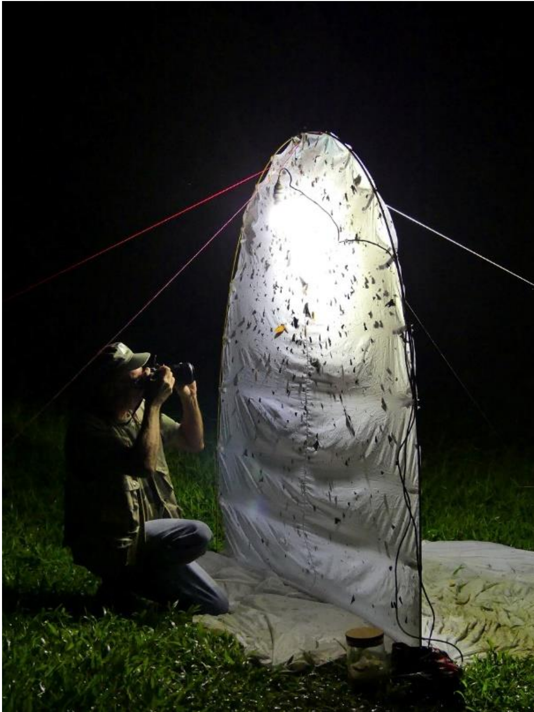
Fig. 7. Piège lumineux fonctionnant sur groupe électrogène. Les insectes attirés par une lumière puissante à fort spectre dans l'UV se posent sur le drap blanc.
