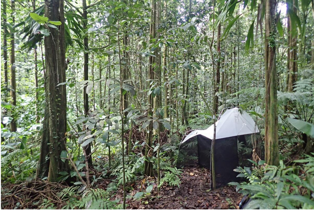
Fig. 5. Piège Malaise Ce piège intercepte les insectes volants. En cherchant à contourner l'obstacle, ceux-ci remontent et sont dirigés vers un angle du piège, où ils passent dans un flacon contenant un liquide de conservation. Très efficace pour les Hyménoptères, Diptères et certains Coléoptères.
