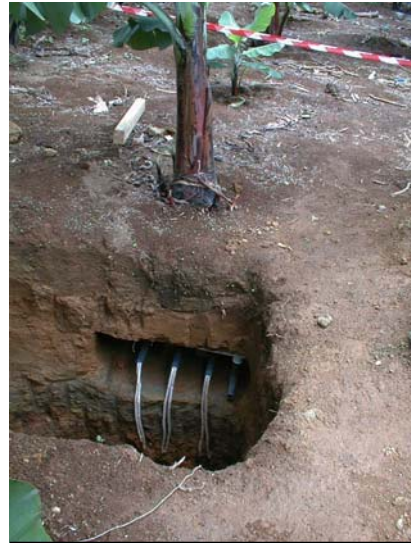
Photo 1 : lysimètre sous bananier
