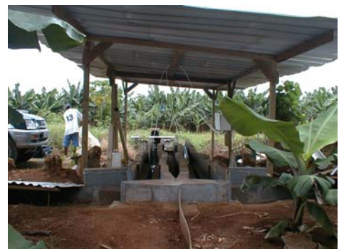
Photo 4 : dispositif de mesure des débits en sortie de parcelle
