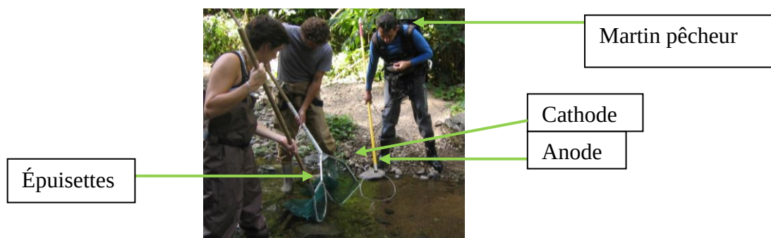
Figure 3: L'équipe de pêche constituée de deux pêcheurs avec épuisettes et d'un pêcheur avec le moteur du « Martin pêcheur » dans le dos, l'anode et la cathode dans l'eau.
